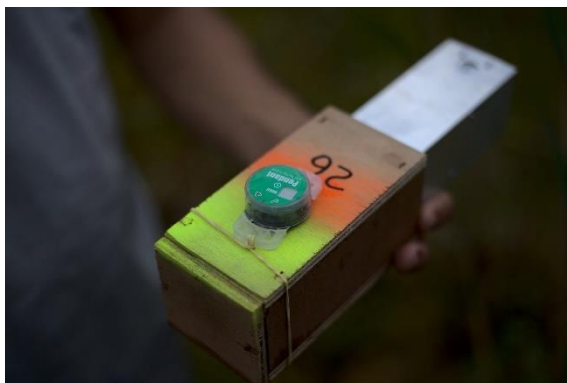
Figure 6 : Enregistreur HOBO MX2202 accroché sur un dortoir de piège INRA (Photo : Florent Mathé)
